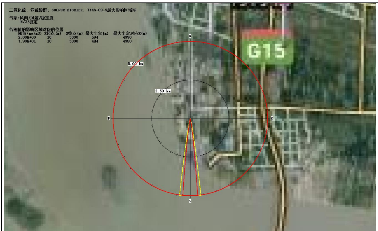
7-10 乙醇汽油火灾事故伴生 SO 2 超风险物质毒性终点浓度范围图
