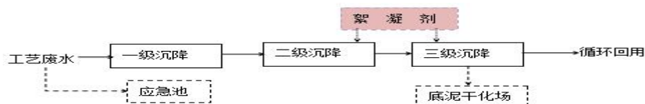
图 7-1 废水处理工艺流程
