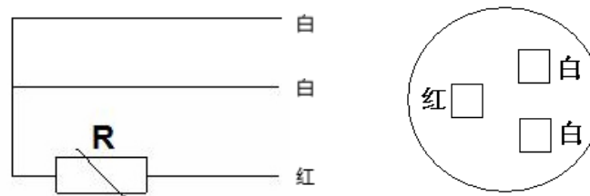
图1 水管安装型传感器电气连接图
