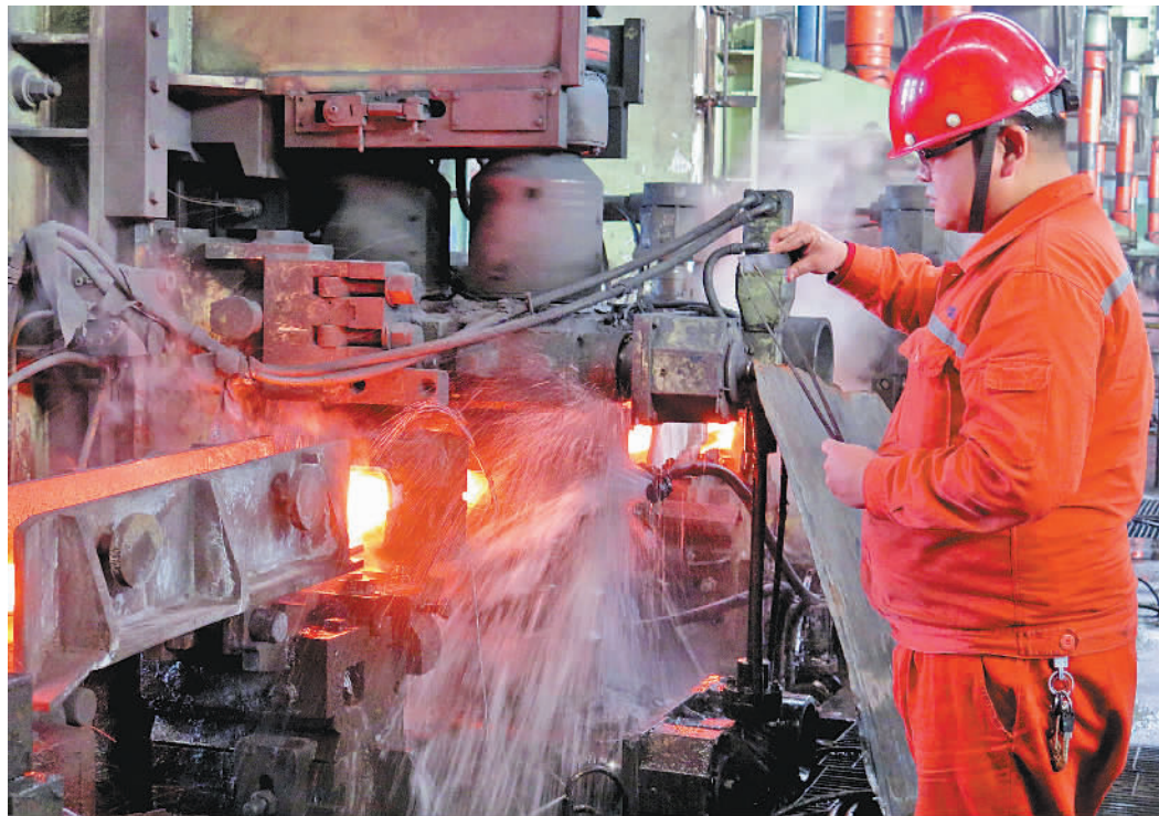
新疆伊犁钢铁有限责任公司粗轧调整工在轧钢厂高线生产线测量红钢尺寸。2015年，伊钢创纪录巨亏6亿元。今年，伊钢通过职工持股、早去产能、精降成本，在行业的寒冷季节探寻钢企“越冬”之道。
