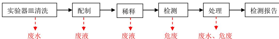
图 3 分析实验室研发流程及其产污环节
