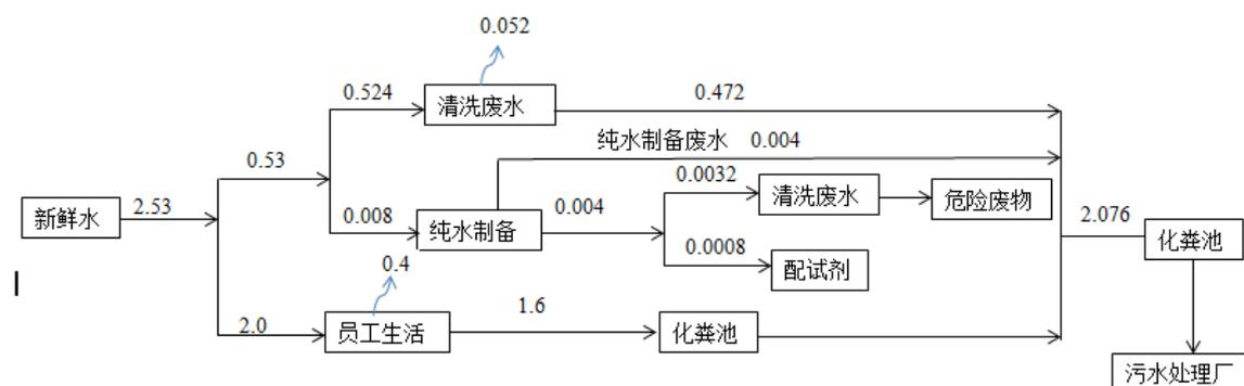
图1 项目水源平衡图
