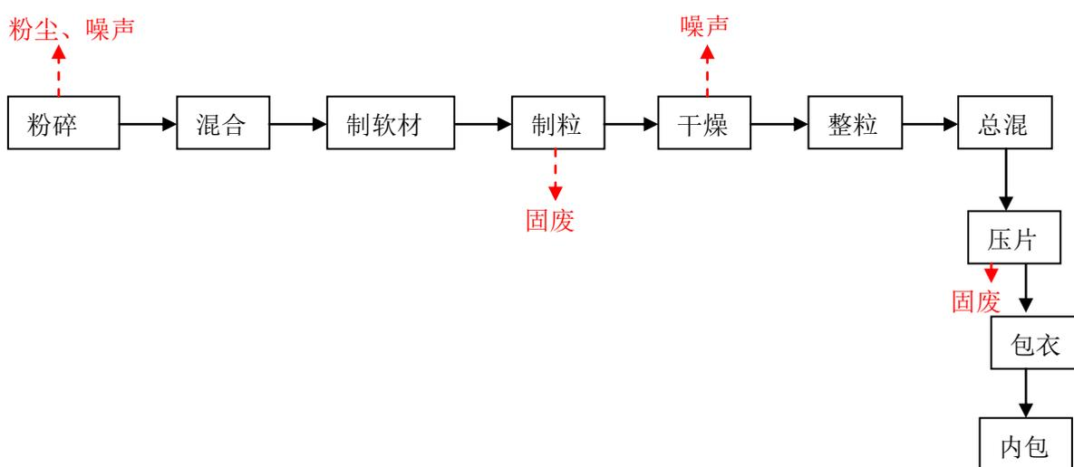
图 3 固体制剂实验室研发流程及其产污环节
