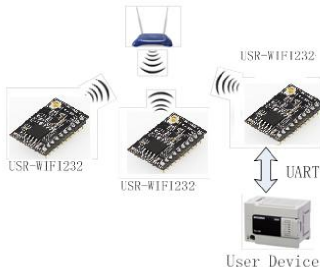
图 2 USR-WIFI232-T 基础网络组网
