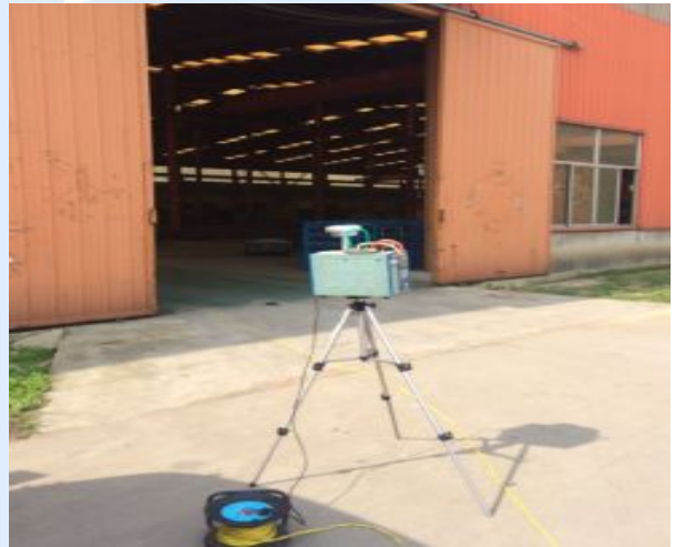
附图 12 厂界废气现场采样
