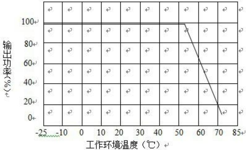
工业级：（加散热片自然冷却下）当工作环境温度超出额定值工作时，请降额使用。
