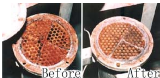
热处理换热器在使用电磁防垢除垢器前后 60 天的对比图
