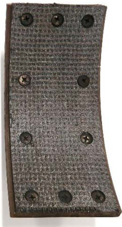
圖11：右制動襯片展示共有十顆固定螺絲
