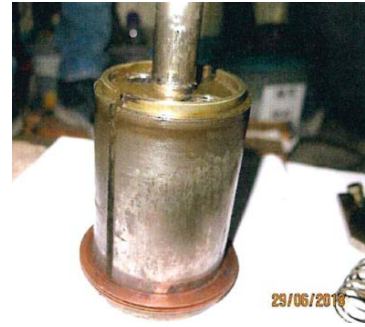
圖9：右制動柱塞的情況 (並無發現潤滑劑)
