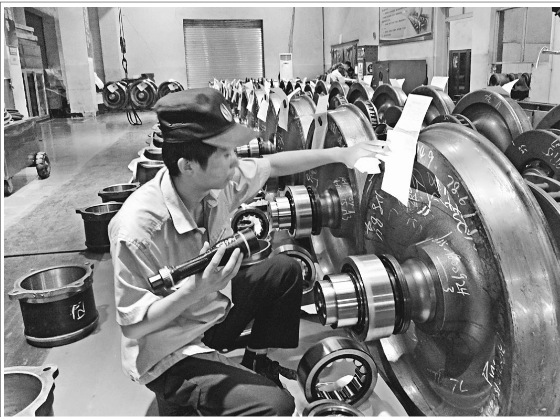
兰铁兰州车辆段检修车间干部职工加班加点,精心加修轮对及其它段修车辆配件,全力做好搬迁前各项准备工作,以保证暑运及段修搬迁过渡期间运用客车使用配件储备充足、质量达标。图为该段质检员在对轴承轴箱组装前进行检查。吴剑摄
