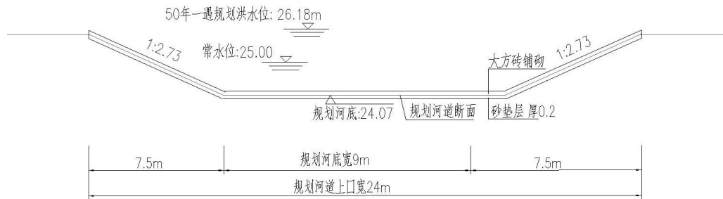
图 1-6 河道护砌示意图 (cm)
