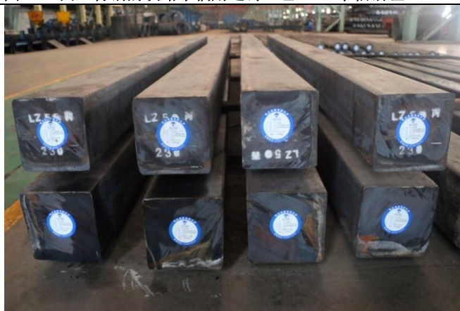
图-26: 西王特钢的铁路车辆用连铸工艺LZ50车轴钢坯
