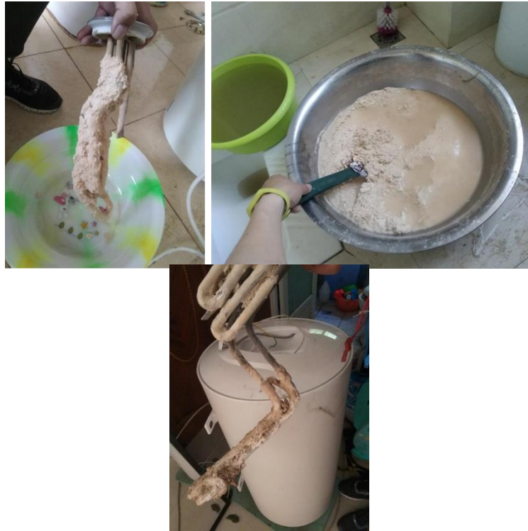
图 5.4-1 实际用户家热水器加热管以及内胆水垢
