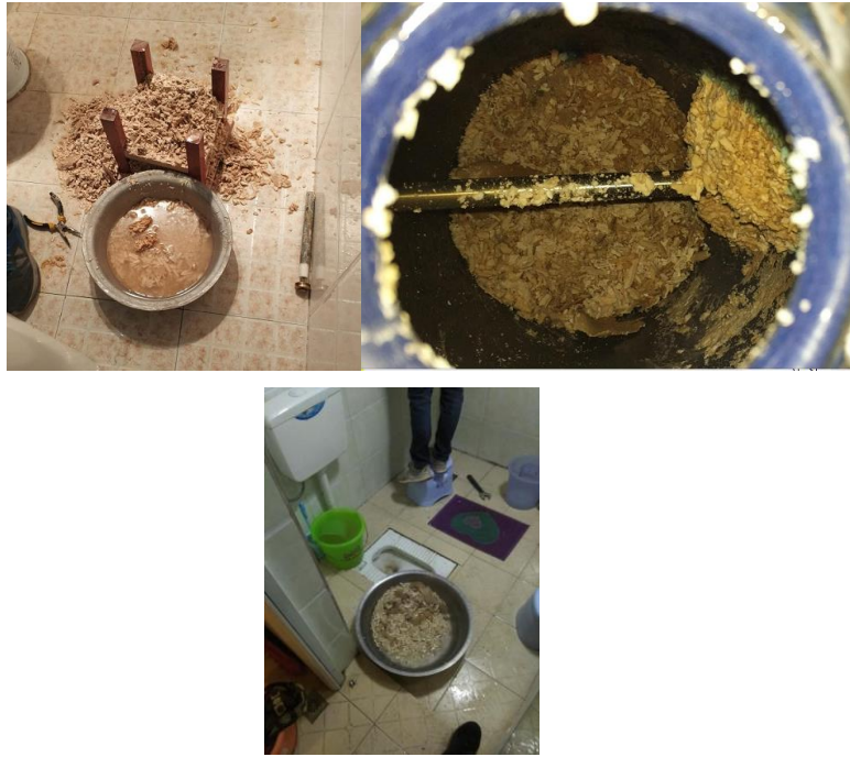
图 5.3-1 实际用户家长期不排水内胆水质情况
