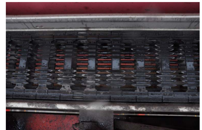
图片注解 0812-03: 耐油污，耐腐蚀，低磨损的 P4 拖链系统能保证各种极端气候下的正常运行。
