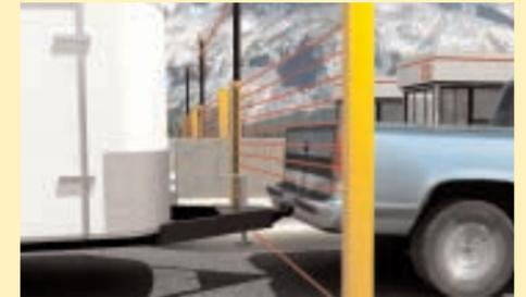
MINI-ARRAY系列车辆分离光幕专为以上难题而设计，它有多对同步工作的发射器/接收器组构成，这种设计可以可靠的分离各种车辆而不会漏检测拖钩，也不会向线圈一样因为车辆行驶过近而误认为一辆车，从而达到自动计重收费的目的。
