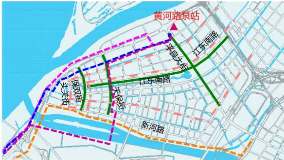
图 4-5 管廊、有轨电车及电力隧道分布图
