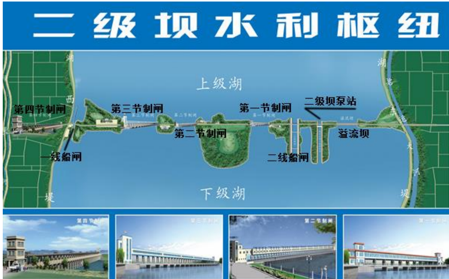
图 1.1-2 二级坝枢纽主要建筑物
