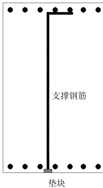
梁钢筋支撑图
