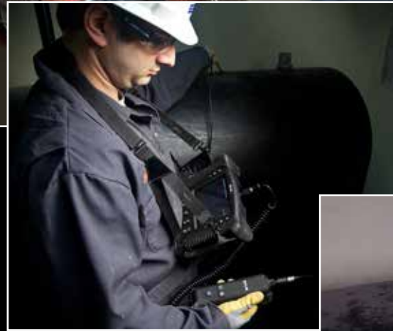
检查飞机引擎和机身裂缝、磨损、缺陷和碎片；检查储油罐腐蚀；检查空气导管堵塞。
