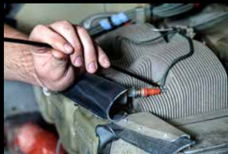
使用VSA2-1M检查飞机引擎汽缸
