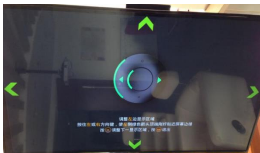
(图 7: 按照屏幕上的文字提示, 使上下左右四个方向的绿色箭头刚好贴近屏幕边缘)
