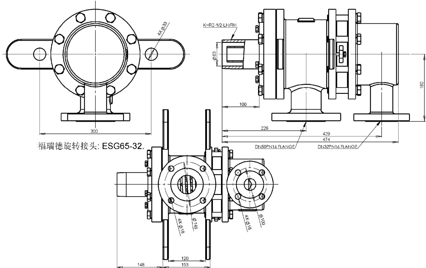
注：1. 图例为 ESG65-32 型双通路、内管 S 固定连接、外管 K 螺纹连接式旋转接头。2. 其它规格可以定做，见第六页型号规格表。
