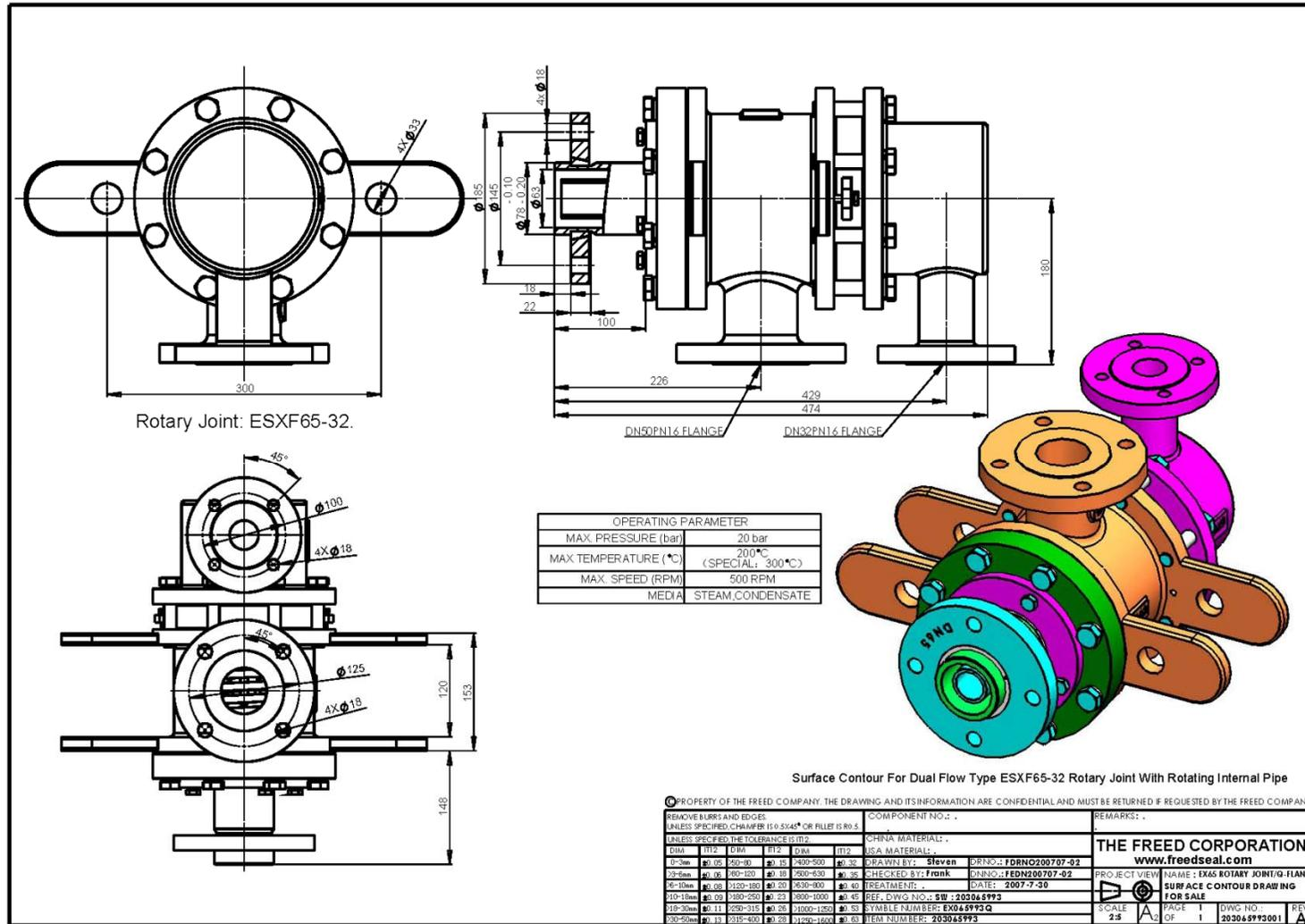
福瑞德 ESXF 型、双通路、内管 S 旋转连接、外管 K 快换法兰连接式、旋转接头图纸
