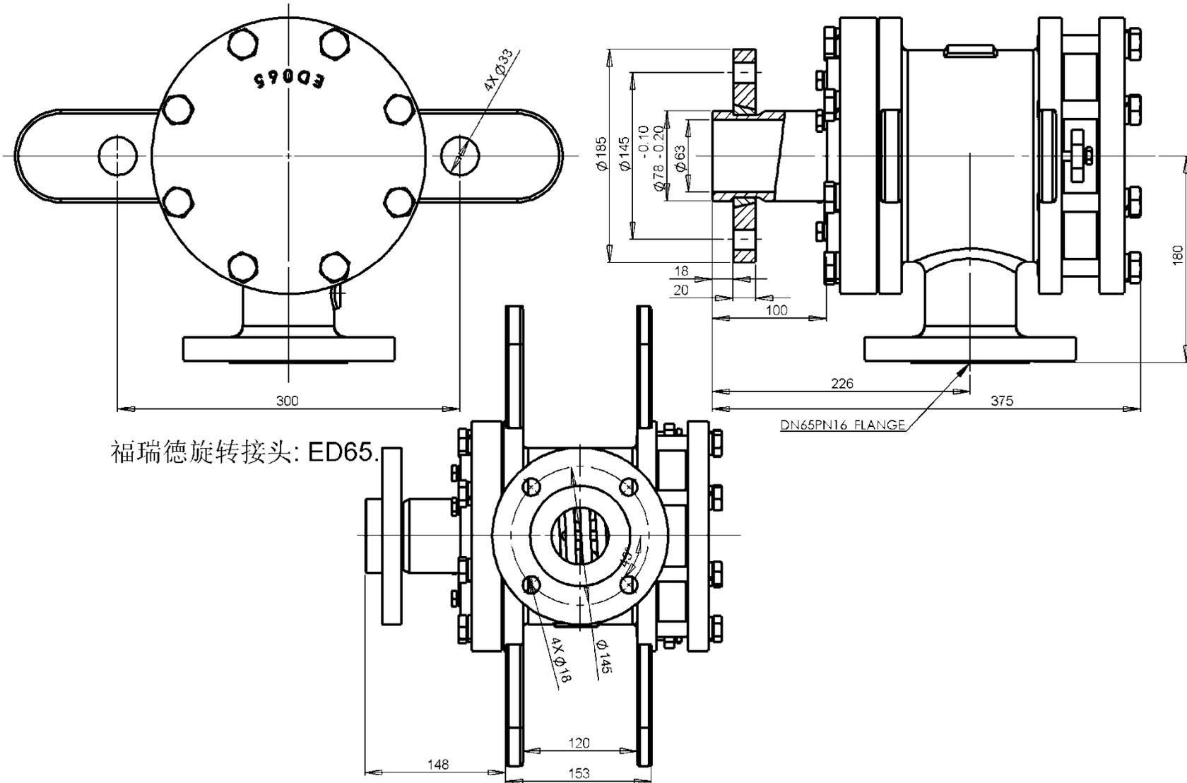
注：1. 图例为 EDF65 型单通路、外管 K 快换法兰连接式旋转接头。2. 其它规格可以定做，见第六页型号规格表。
