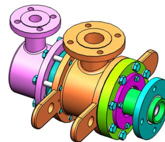
QSGF 型、双通路、内管 S 固定连接、外管 K 快换法兰连接式、旋转接头
