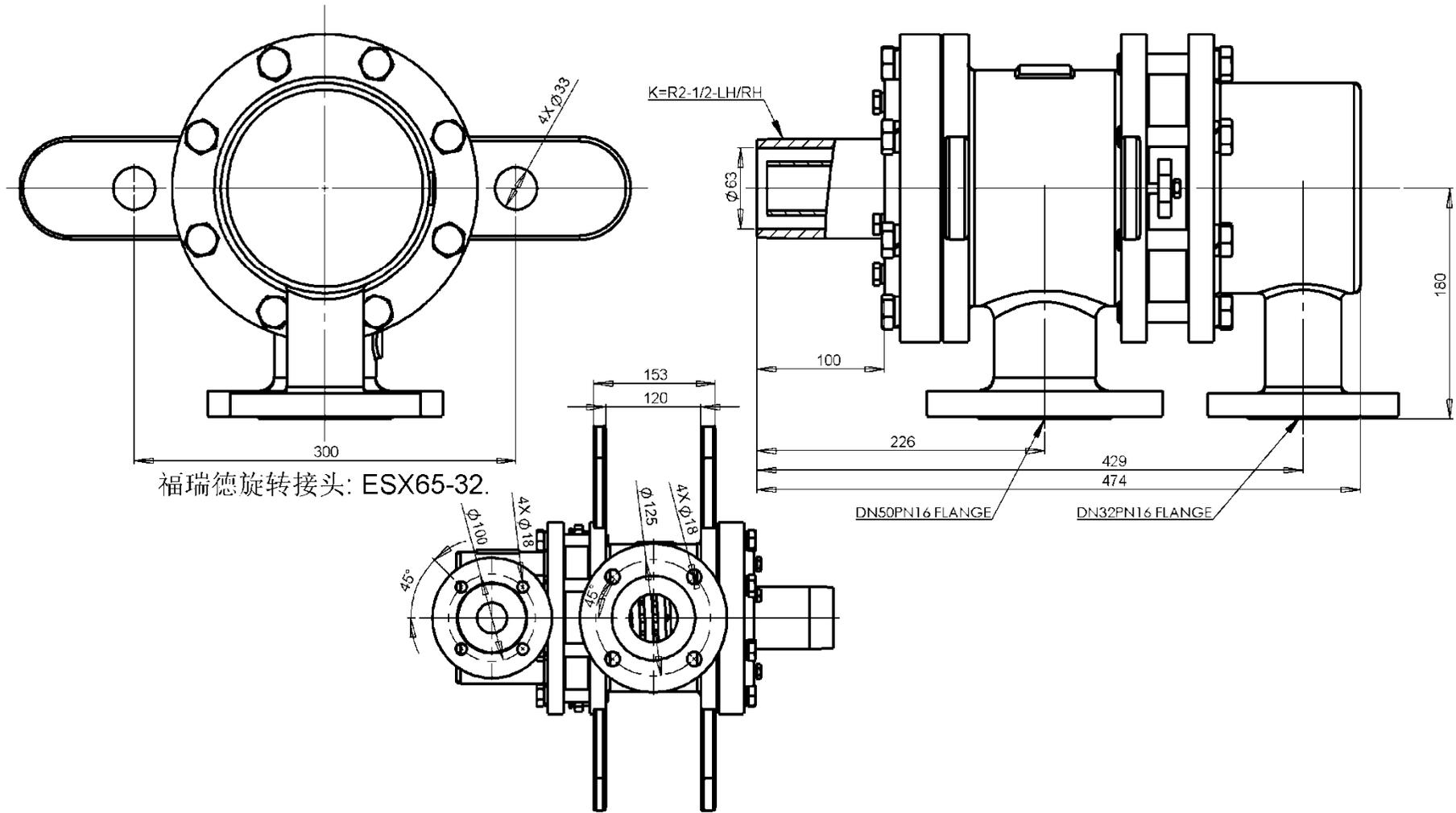
注：1. 图例为 ESX65-32 型、双通路、内管 S 旋转连接、外管 K 螺纹连接式旋转接头。2. 其它规格可以定做，见第六页型号规格表。
