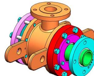
QDF 型、单通路、外管 K 快换法兰连接式、旋转接头
