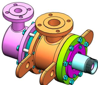
QSG 型、双通路、内管 S 固定连接、外管 K 螺纹连接式、旋转接头
