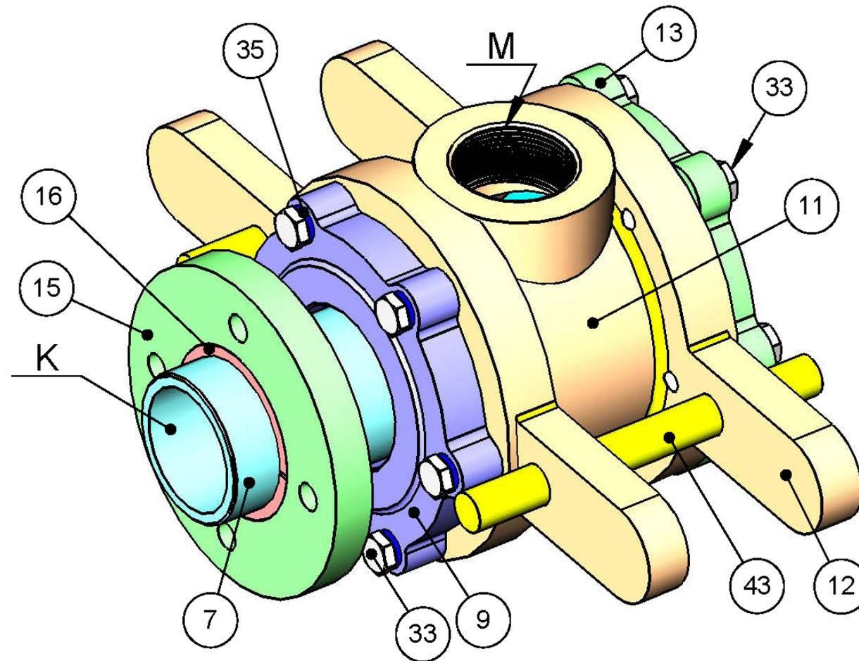
图示为 EDF、单通路、外管 K 快换法兰连接、EDF 型旋转接头
