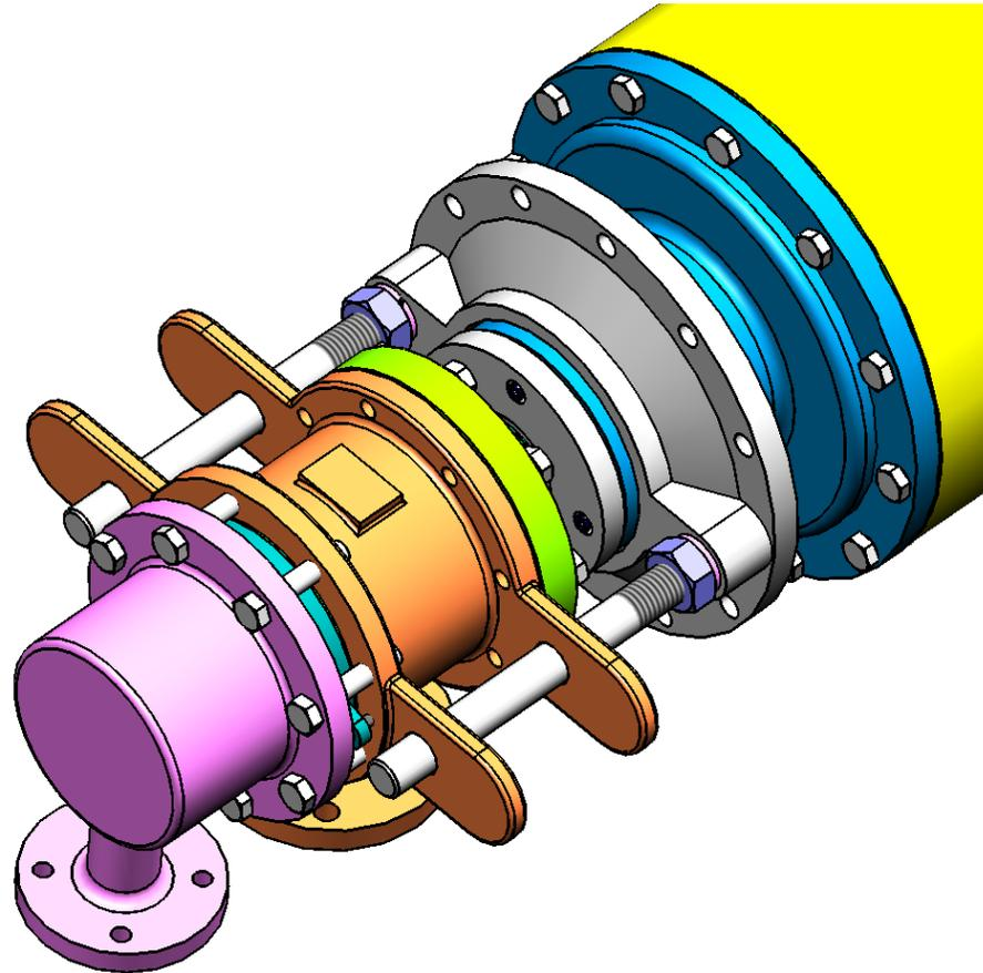
图示为 ESXF 型、双通路、外管 K 法兰连接、E 型旋转接头安装示例
