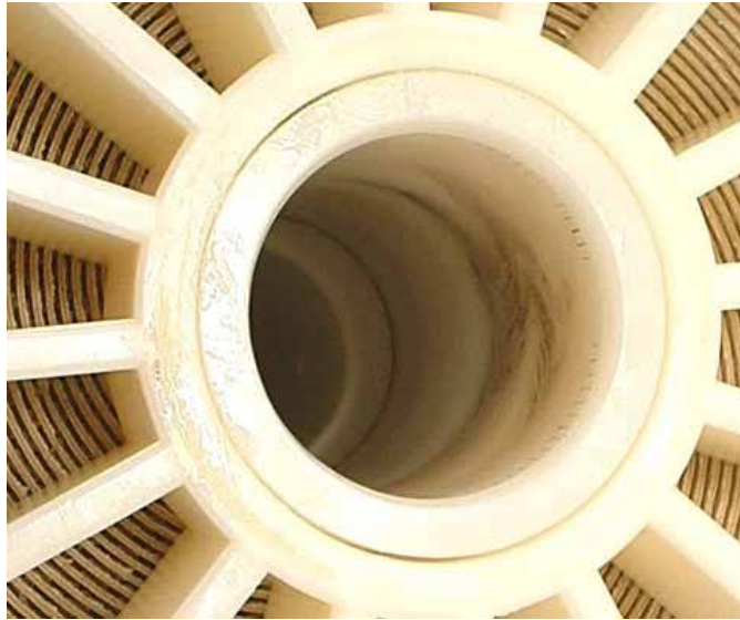
图 5. 第 5 号压力容器中 1 号膜元件发生 O 形密封圈磨损的照片
