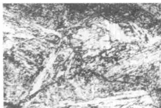
图 3 35CrNi3MoV 钢去氢退火后的粗大晶粒 \times 100
