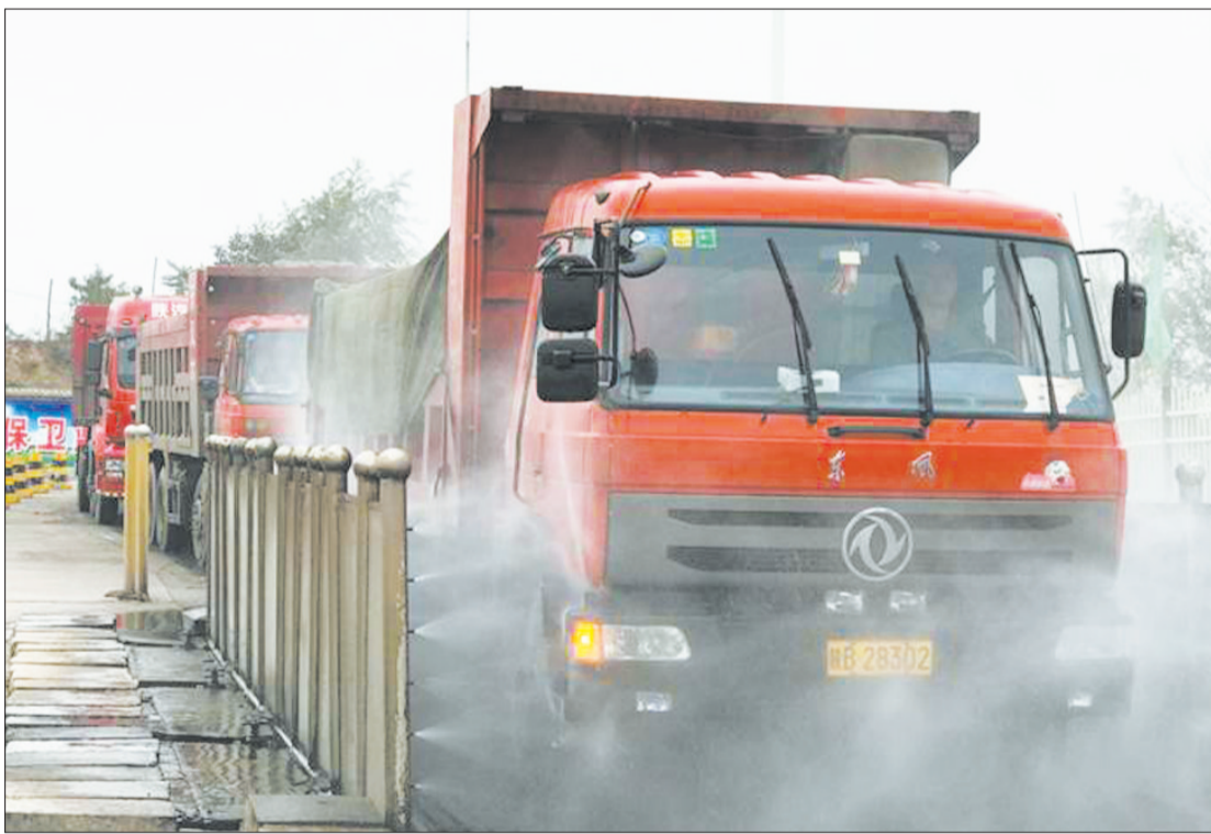
陕西省铜川市耀州区积极落实“治污降霾·保卫蓝天”行动计划,在运输车辆集中路段建设清洁服务站,对过往车辆进行高压、大水流冲洗,减轻道路扬尘污染。 件博摄
