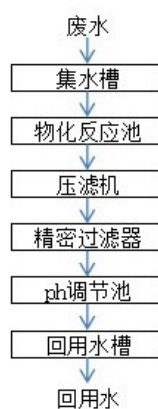
图 7-3 废水污水站工艺流程
