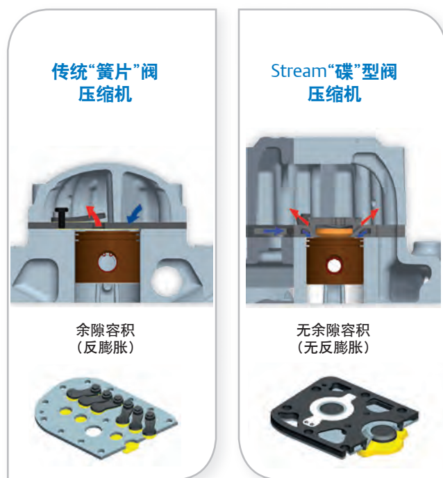
图1:传统簧片压缩机(左)和Discus碟阀压缩机(右)排气阀对比
