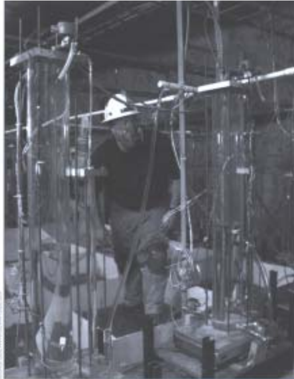
尤卡山项目科学家测试尤卡山内侧岩石中水的移动情况。
