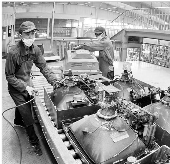
北京市采取市区两级环保部门监管,通过视频监控、污染物排放监测、定期现场检查等手段,对废弃电器电子产品处理企业的拆解行为实行全过程监管。图为北京华新绿源环保产业发展有限公司废旧电视无害化拆解处理线。
