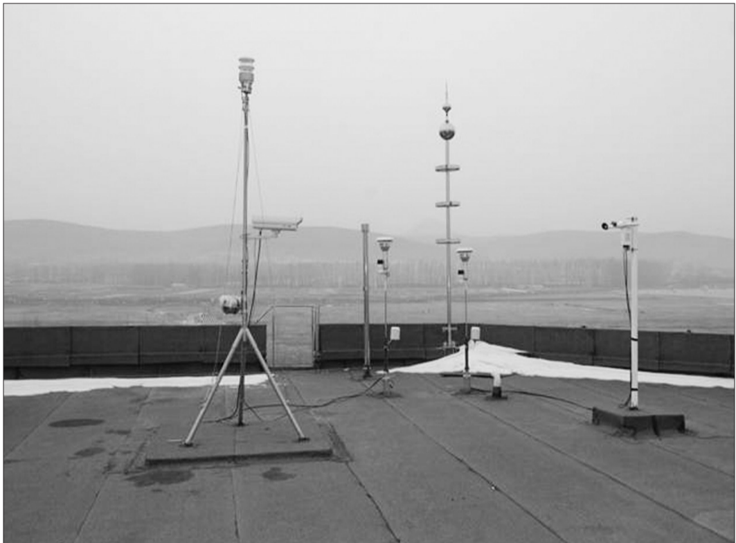
吉林省延吉市PM 2.5 监测仪近日正式上岗,今后延吉市空气质量将处于实时监测中。延吉市2014年被纳入全国空气质量新标准第二阶段监测实施范围及国控空气质量监测点,目前在延吉市环保局、延边医院、朝阳川污水处理厂设立了自动监测点。图为一处监测点楼顶的采样设备。 韩龙玉摄
