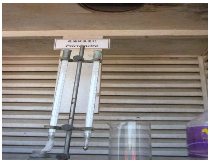
測量空氣溫度和濕度的一對並列安置的溫度計
