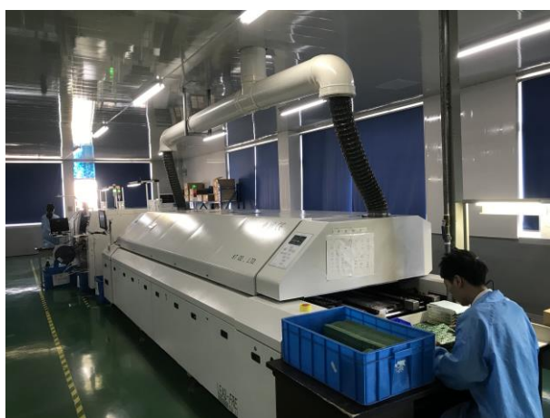
图 4-4 焊机上方烟尘收集管道照片
