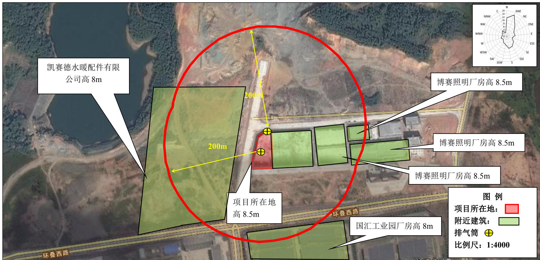
附图五 排气筒周围 200 米建筑高度图
