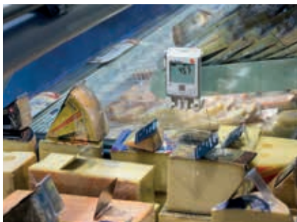
超市冷冻柜温度监测 外置温度，需外接温度探头(NTC) (testo Saveris 2-T2)
