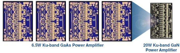
图表 24: GaN 较 GaAs 大幅减少体积
