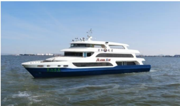
图 2：48m 钢-铝合金复合岛际交通船
