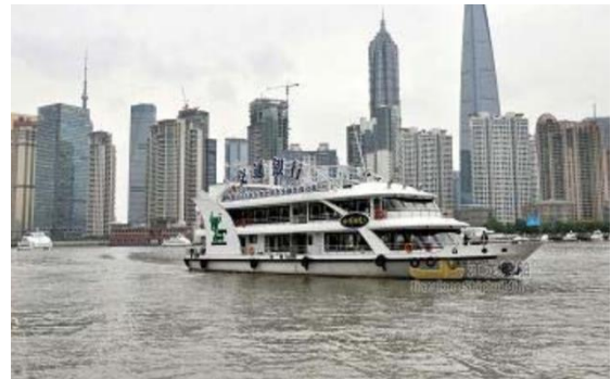
图 3：40.5m 钢-玻璃钢复合旅游观光船
