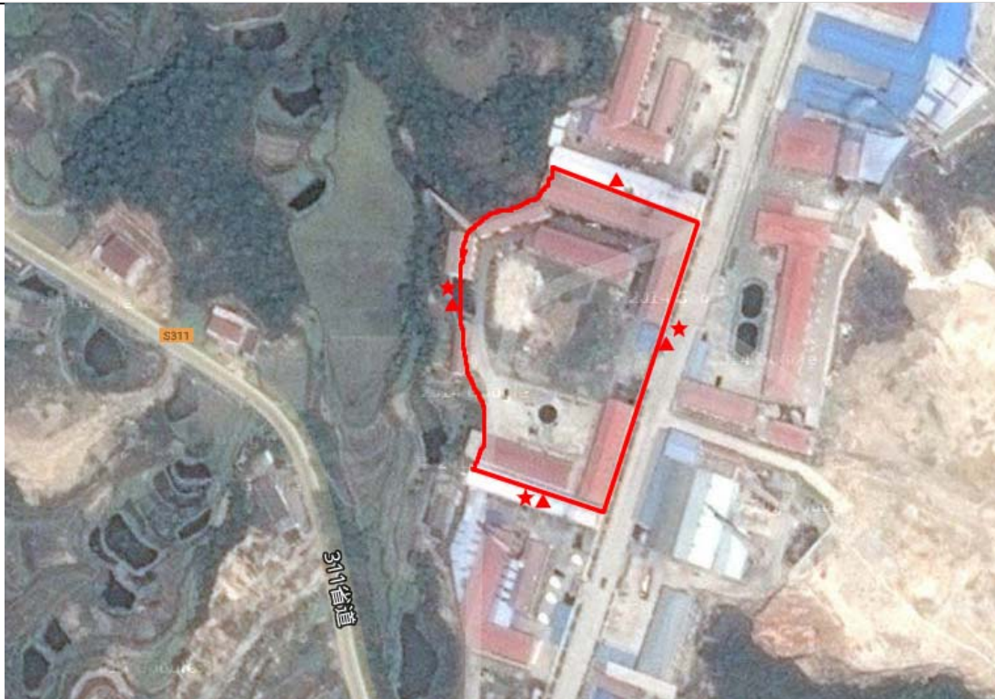
图 9-1 环境监测点位布设示意图 (★无组织废气监测点; ▲厂界噪声监测点)
