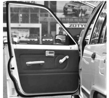
C. 手摇式车窗控制机构
