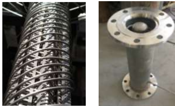
图 20. 新型提馏段内部换热结构局部图及整体图
