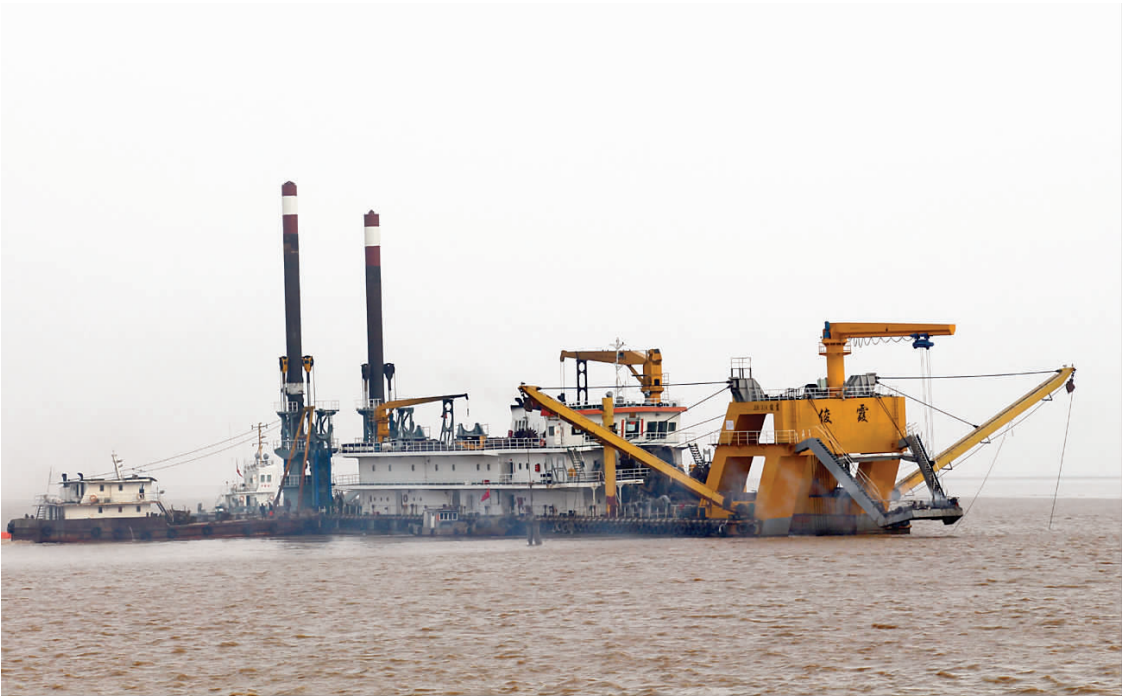
春节期间,射阳港航道二期疏浚工程正常施工,2艘大型绞吸式挖泥船和1艘耙吸式挖泥船全力投入航道疏浚,已完成疏浚土方量约300万方。图为航道疏浚施工场景。
