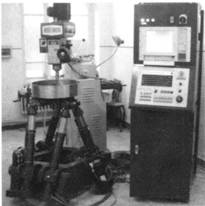
图 1 6-TPS 并联平台型数控机床
