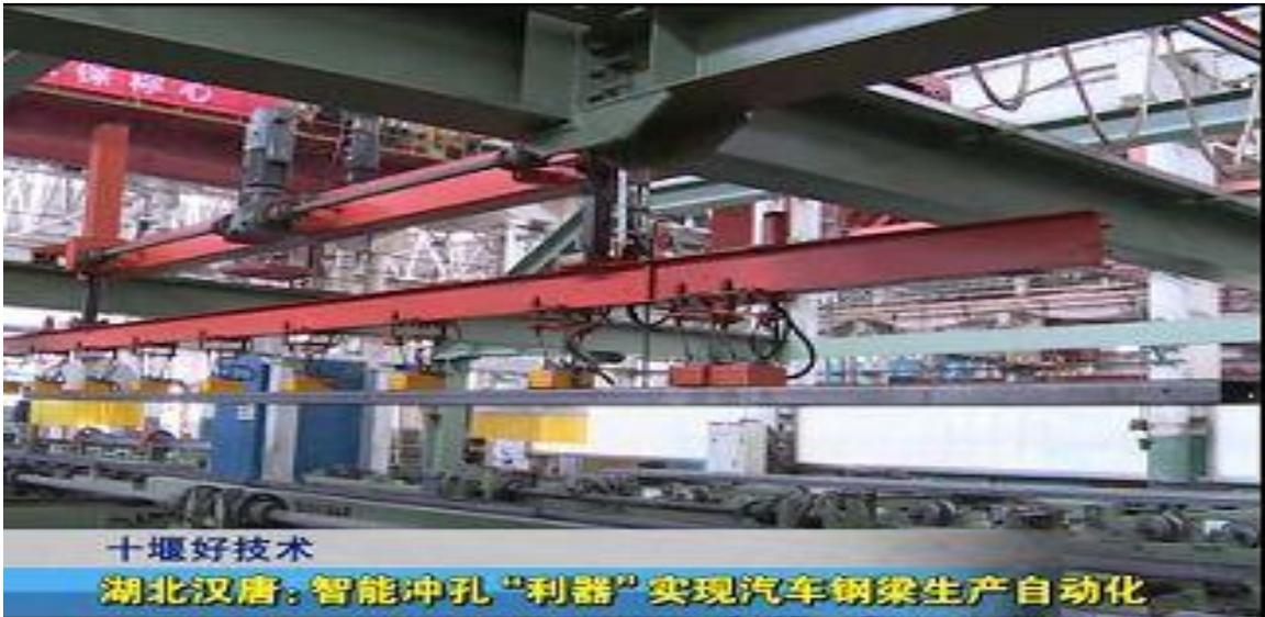
2018 年 4 月 24 日，十堰市科技局、十堰市生产力促进中心组织专家团一致认为我公司“机器人汽车双层钢梁智能镶合配冲孔生产线”研发项目符合验收条件，同意通过评审验收。该项技术曾获评 2017 年度“十堰好技术”。智能冲孔“利器”实现汽车钢梁自动化！
