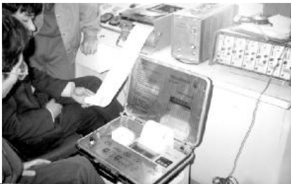
中科智能在国家电梯检测中心进行第一代电梯加速度测试仪实验。
