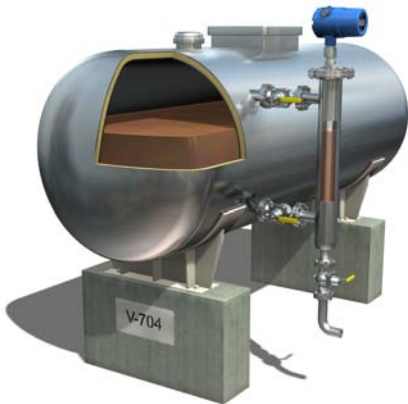
带罗斯蒙特 9901 和过程液位仪表的卧式储罐
