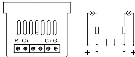
注意: 拆装带灯安装板时要轻拉轻插, 避免损坏带灯安装板和插座。
