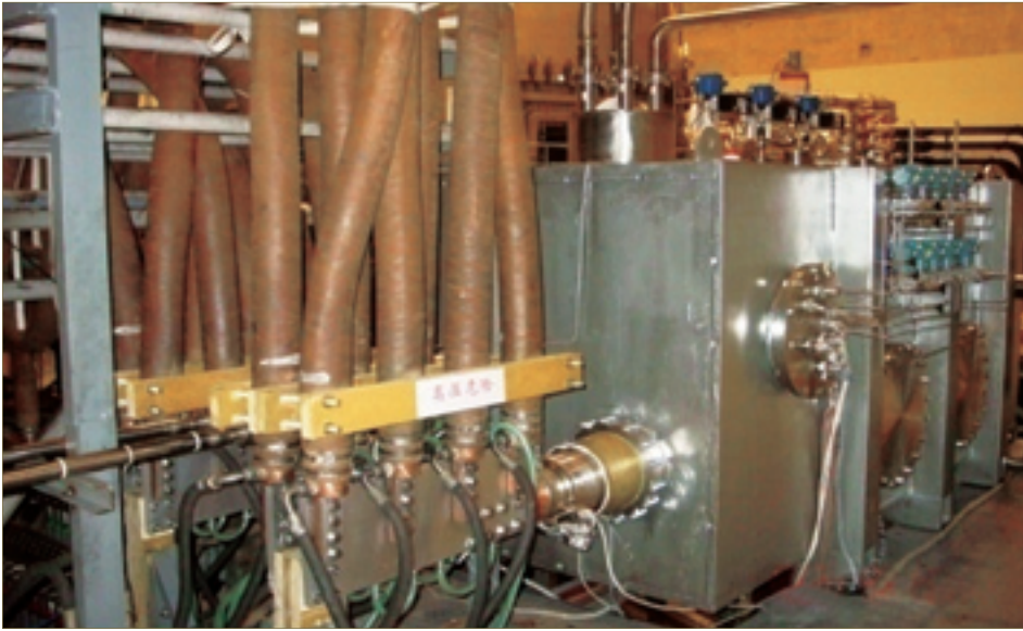
图 8-9 ITER 69kA 高温超导电流引线冷测试装置
