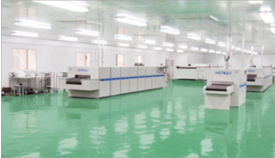
图 8-3 染料敏化太阳能电池中试线车间
