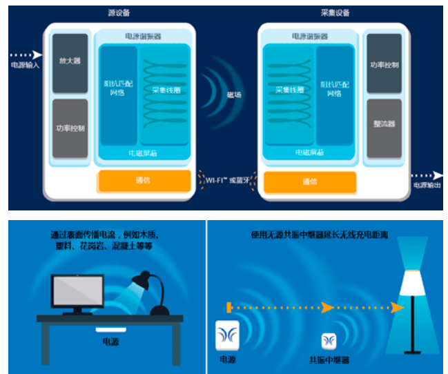
图 1: 上: WiTricity 技术背后的概念, 包括线圈、控制电源输出和管理的电子设备、用于保证电源和采集设备之间正确电源输出的无线通讯。下: 此项技术支持通过不同的材料表面进行充电 (左); 可以通过谐振中继器延长无线充电距离 (右)。
