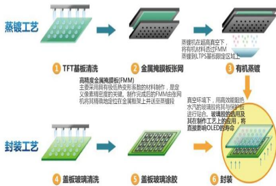
图表 16:有机镀膜段工艺流程图
