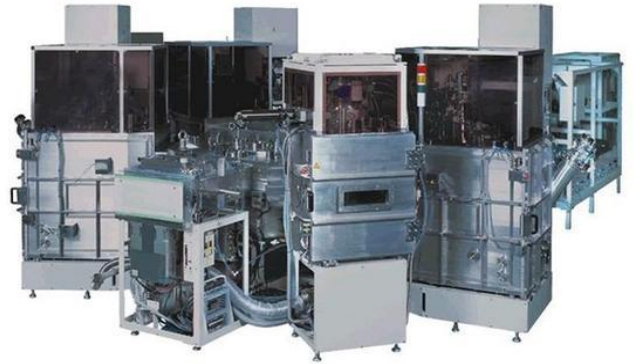
图表 17:OLED 蒸镀生产设备
