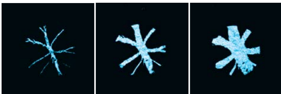
爆破箔片的典型破裂 ▼
