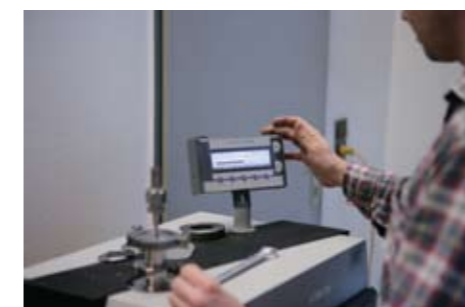
▲ 氮气泄漏试验
