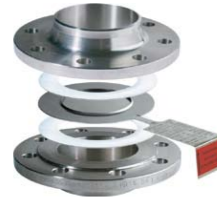
▲ 直接安装在法兰之间的复合爆破片
