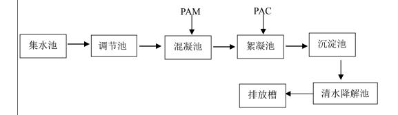
项目的生产废水经自建生产废水处理站处理后,能达到《陶瓷工业污染物排放标准》(GB25464-2010)中表 2 新建企业水污染物排放浓度限值的直接排放限值,项目生产废水经处理达标后排入白云水后汇入枫江。根据枫江的监测数据,枫江中部分指标已超标,水质一般。分析水质超标原因,可能是流域附近村民生活污水直接排放和部分工厂将未处理达标的污水直接排放,导致枫江的水质较差。潮州市第二污水处理厂位于潮安区凤塘镇,该厂已于 2018 年底建成运营,设计规模为日处理污水 6 万吨,目前接纳市区南片、枫溪区大部分地区、潮安区浮洋和凤塘等镇部分区域的污水,随着潮州市第二污水处理厂污水管网铺设的逐
